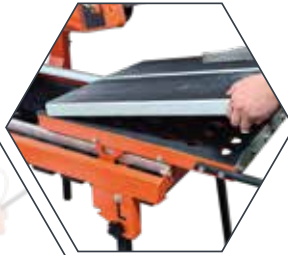
Schnelle Rückrüstung auf Nassschnitt - werkzeuglos
