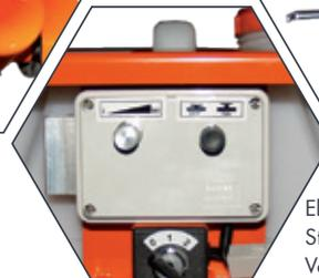
Elektrostart + Steuerpult für Vorschubgetriebe
