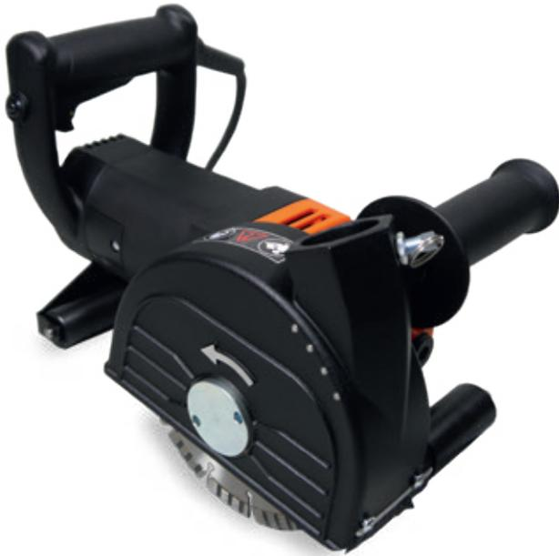
Schlitzfräse für das Fräsen bis zu einer maximalen Schnittbreite von 46 mm und einer Schnitttiefe von max. 45 mm.
