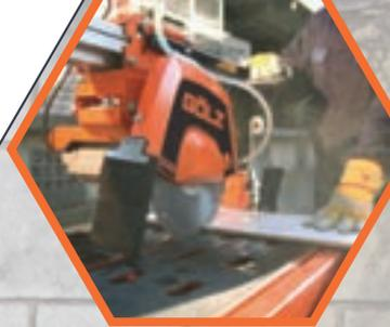
GS350 Brückensägen sind ideal zum Schneiden von Natursteinplatten aus Granit oder Marmor, sowie Feinsteinzeugplatten. Die verwindungsfreie Brücke mit dem rollengeführten Schneidkopf gewährleistet präzise und gerade Schnitte, auch bei 45° Gehrungsschnitten. Brückensägen der Baureihe GS350 sind lieferbar in Stahlausführung mit bis zu 1.200 mm Schnittlänge und in Aluminium Ausführung mit bis zu 2.200 mm Schnittlänge.
