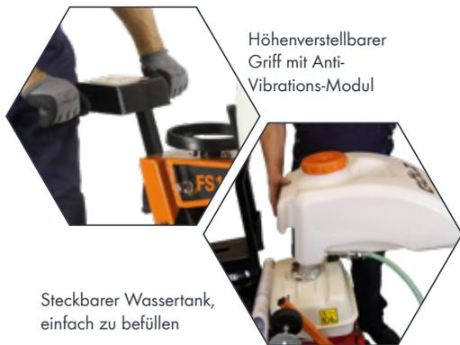
Höhenverstellbarer Griff mit Anti-Vibrations-Modul
