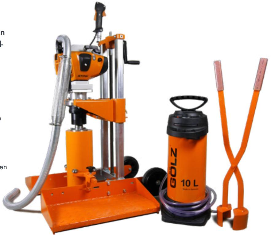
Bohren von Prüfkernen
